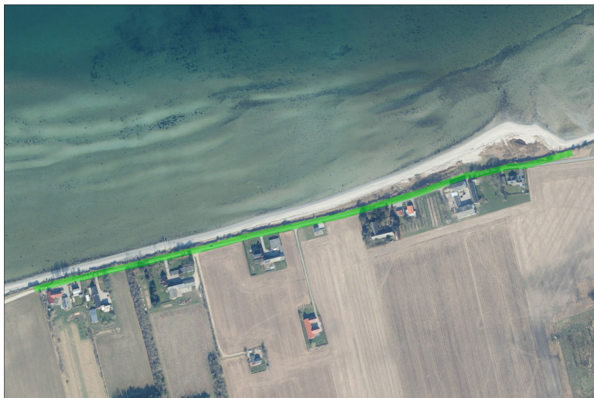
Figur nr. 2 viser estimeret påvirkning af akuterrosion over 50 år på delstrækning 3, ved Fogense
